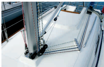
Viel Aufgeräumtes: Sämtliche Leinen und Strecker sind nach achtern umgelenkt
