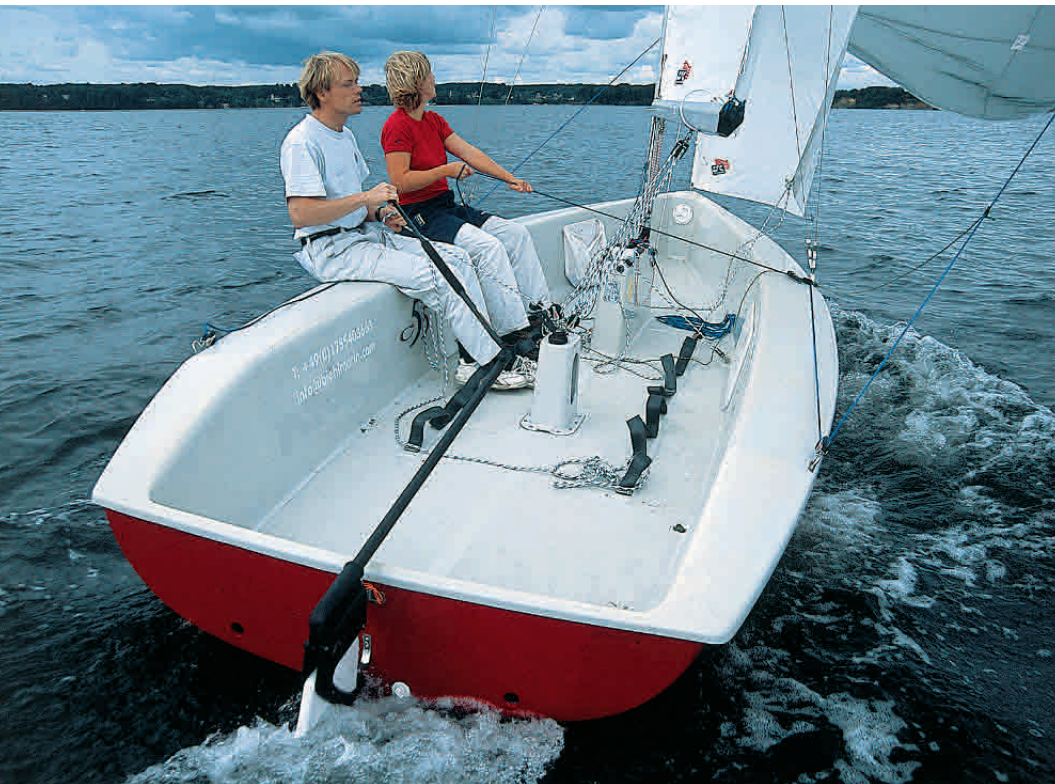
Große, offene Plicht: Das Cockpit ist geräumig genug zum Wasserwandern. Es soll vier Personen ausgestreckt schlafend beherbergen können. Das Gepäck kann ins Vorschiff
