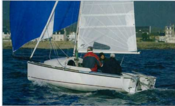
▲ Sur les deux Ikone, les deux safrans sont accrochés sur le tableau et réunis par une barre transversale. Chaque barre a son stick permettant de barrer au vent, assis sur le plat-bord.
