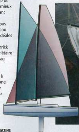
Le mât de l'Ikone J ne comporte aucun haubanage et son cockpit est dépouillé.
