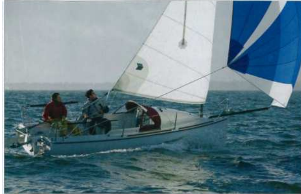
▲ Sous spi, l'Ikone J doit s'incliner devant le sloop en raison de son mât tournant non haubané. Notez, au niveau de la grand-voile, la latte verticale qui tient sa chute.
